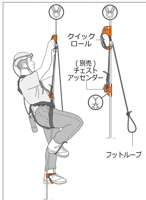
図 6 クイックロールの使用例
